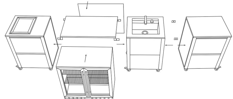
Beispiel für die Verbindung von Kochmodulen: Kühlschrank mit Verbindungsbrücke, Spüle, Teppanyaki und Basis Modul.
