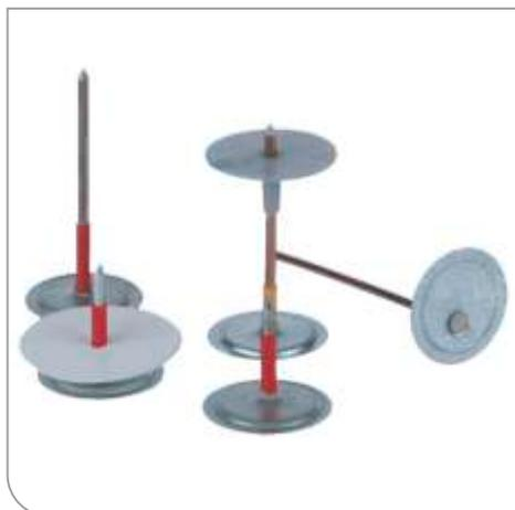
Die Kombination von Schweißstift und Sicherungsscheibe ermöglicht die Befestigung von Dämmstoffen auf Blechen in einem Arbeitsgang. Durch die Schaftisolierung können Dämmstoffe mit Aluminiumkaschierung bzw. mit Drahtnetz problemlos befestigt werden.
