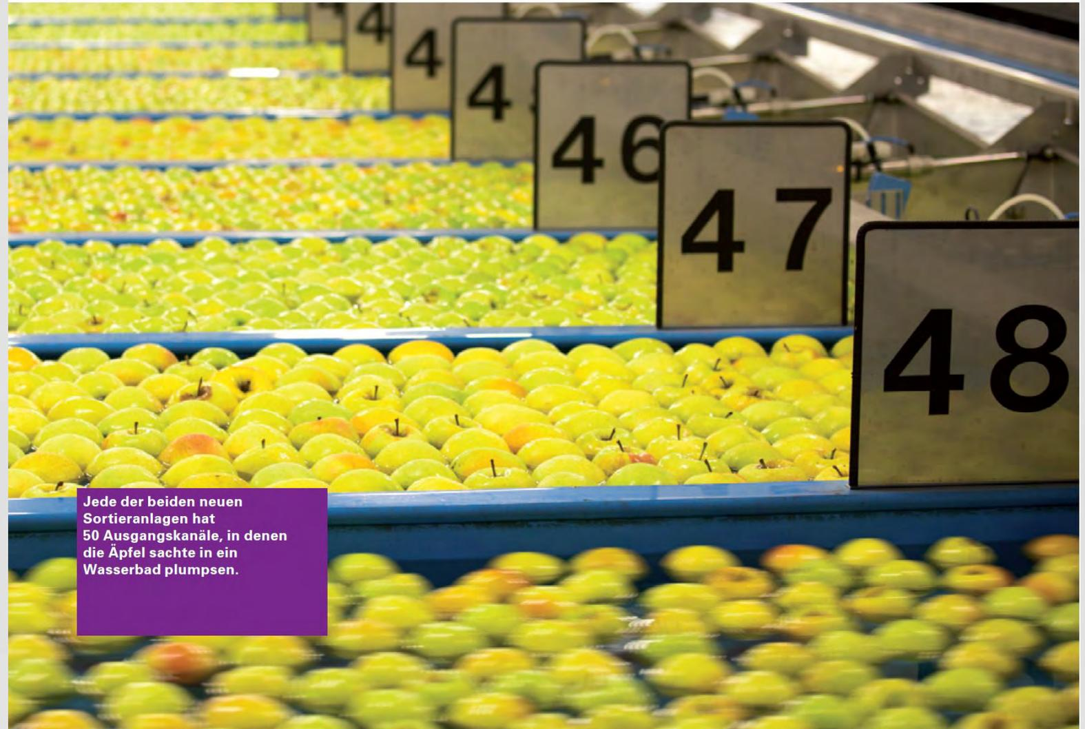
Jede der beiden neuen Sortieranlagen hat 50 Ausgangskanäle, in denen die Äpfel sachte in ein Wasserbad plumpsen.
