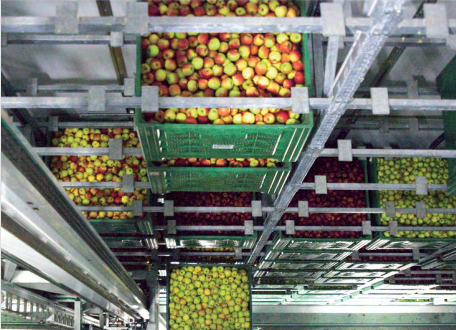
Das Hochregallager ist ein vollautomatisches Kühlhaus mit normaler Atmosphäre, welches bis zu 7.500 Plastikgroßkisten mit je 330 kg fasst. Gesamt ergibt dies ca. 2.500 Tonnen.
