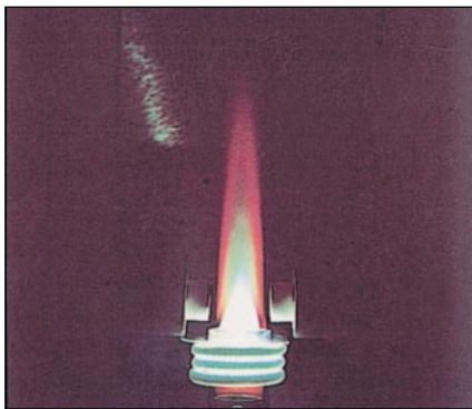
Figura 15 - Fiamma di plasma in uno spettrometro ICP (dalla citazione 10)
