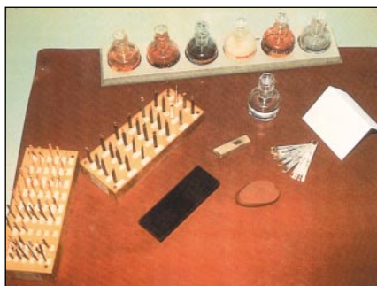
Figura 6 - Attrezzatura per la prova con la pietra di paragone (dalla citazione 12)
